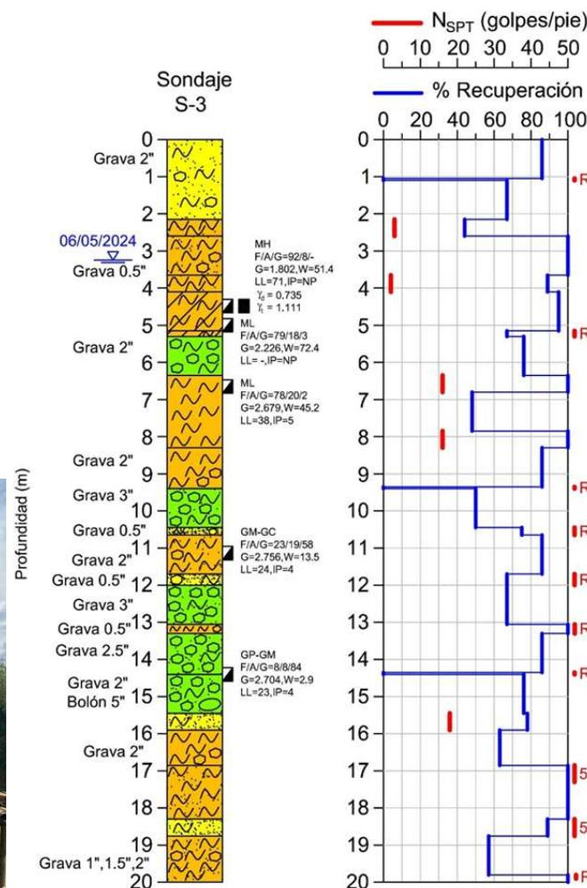
Resultados de la estratigrafía para el sondaje S3 con los resultados de los ensayos de laboratorio.
