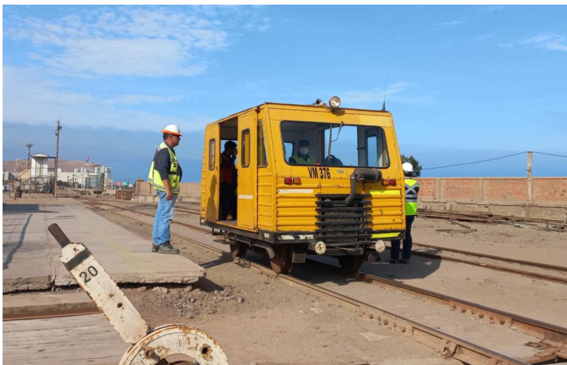
Fotografía: Motovia utilizada para recorrer las vías y realizar la inspección
